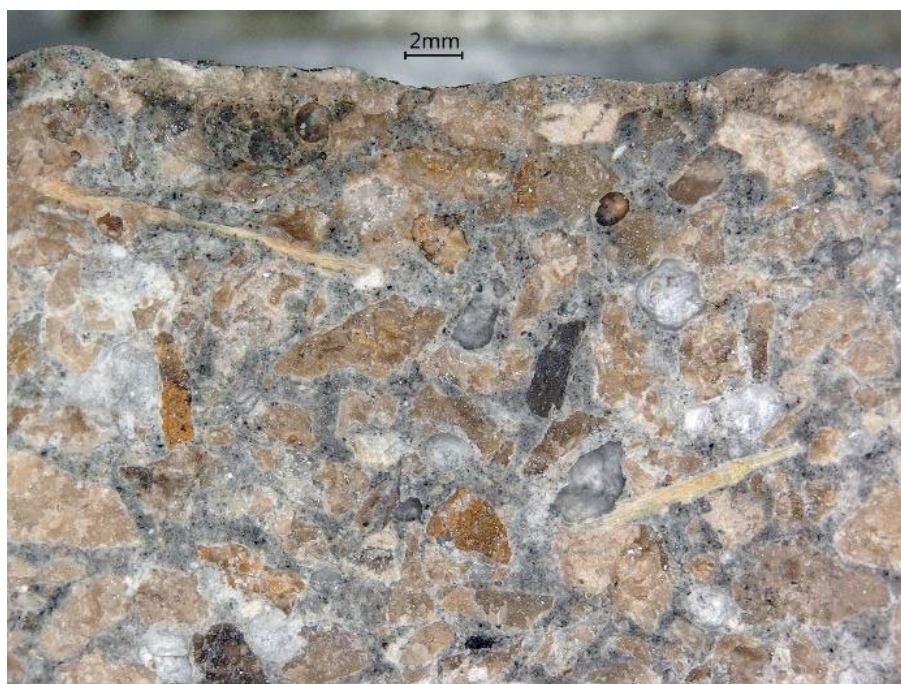
Fig. 6. Timișoara, Palatul Băncii Szana (1921-1922): fragment de simlipiatră de la balustrada balcoanelor, văzut la microscopul digital (Foto: Prof. J. Weber 2023).
