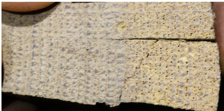
Fig. 2. Secțiune/detaliu de la o probă prelevată la biserica din Brusturi, pe care se poate distinge limita zonei de alburn.
