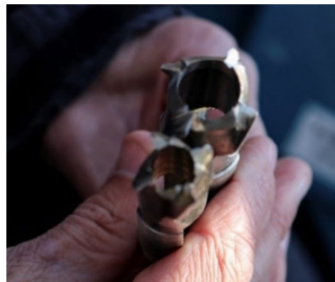
Fig. 1. Burghie cu diametre diferite pentru prelevarea carotelor: mai mic pentru arbori de esență tare, mai mare pentru rășinoase.
