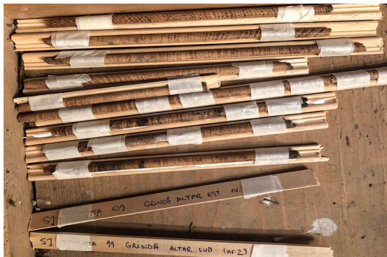
Fig. 8. Biserica de lemn din Bocșița - carote dendrocronologice.
